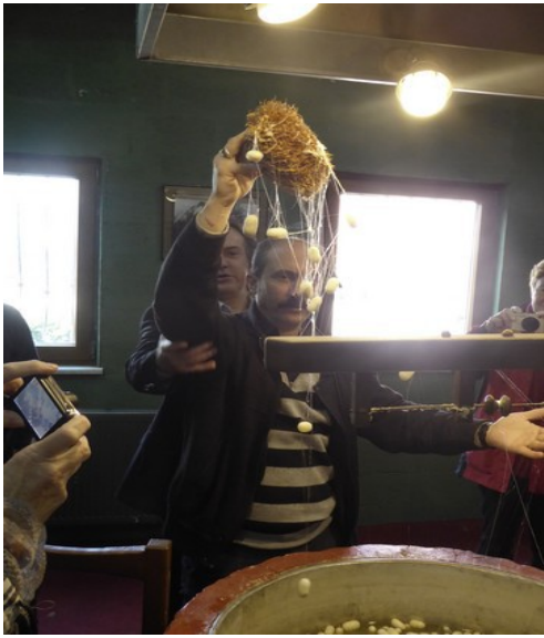
Denne karen bruker en kost til å fange opp silketrådene slik at de kan spinnes opp.
