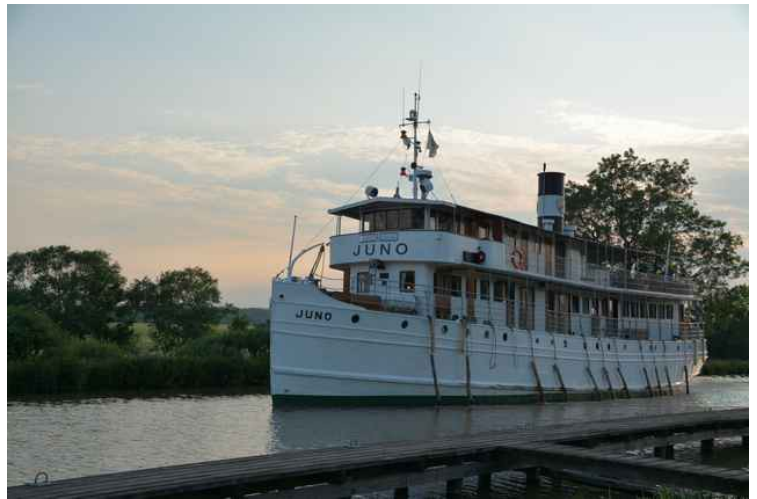
Fenderne henger ute for å beskytte skroget i slusene.
