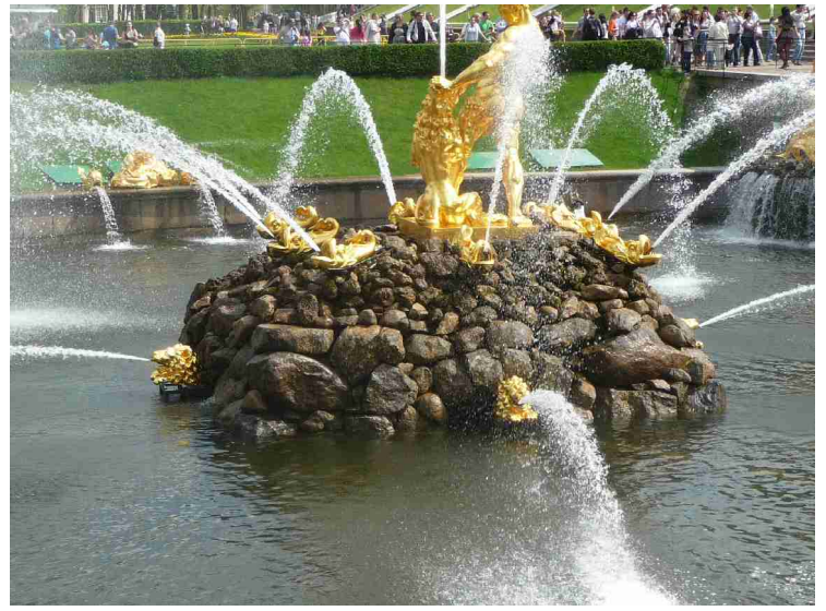
Det er gull i fontenene også. Det er verdt å merke seg at vannet kommer i akvedukter fra et høydedrag utenfor Peterhof og at alle fontenene fungerer ved naturlig fall uten bruk av pumper.
