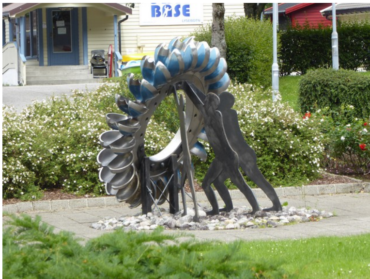
Dette er et skovlhjul som har stått i en Peltonturbin .
