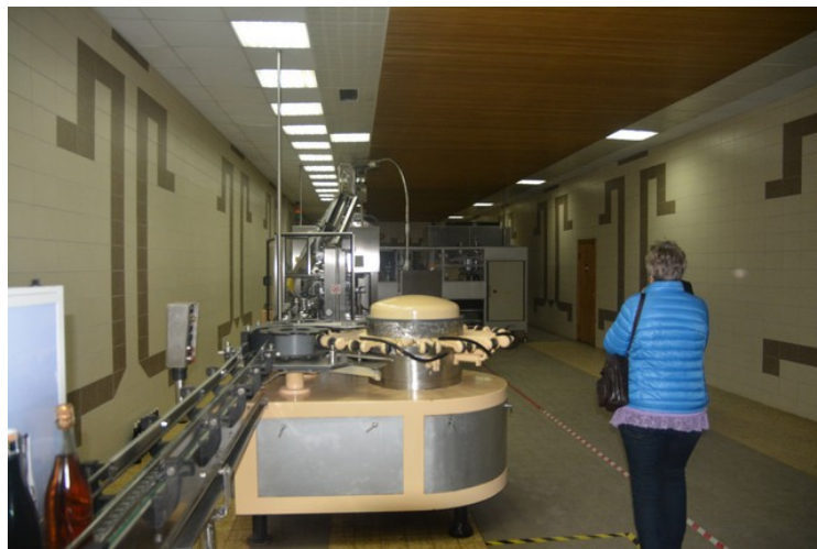
Maskineri for å tappe og korke musserende vin.
